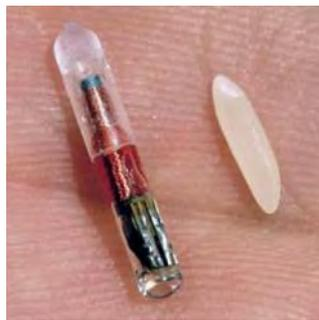
FIGURE 10 - COMPARAISON DE LA TAILLE D'UNE PUCE RFID IMPLANTABLE CHEZ UN ETRE VIVANT ET UN GRAIN DE RIZ
